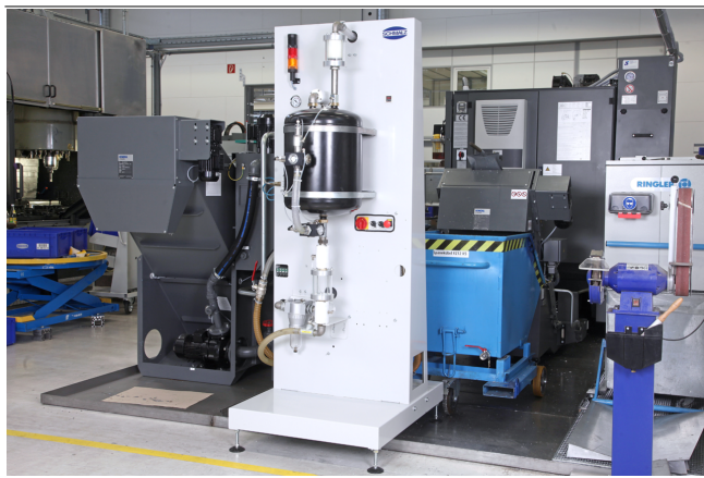
Vacuum Operation Center VOC para la generación de vacío en el mecanizado con taladrina
